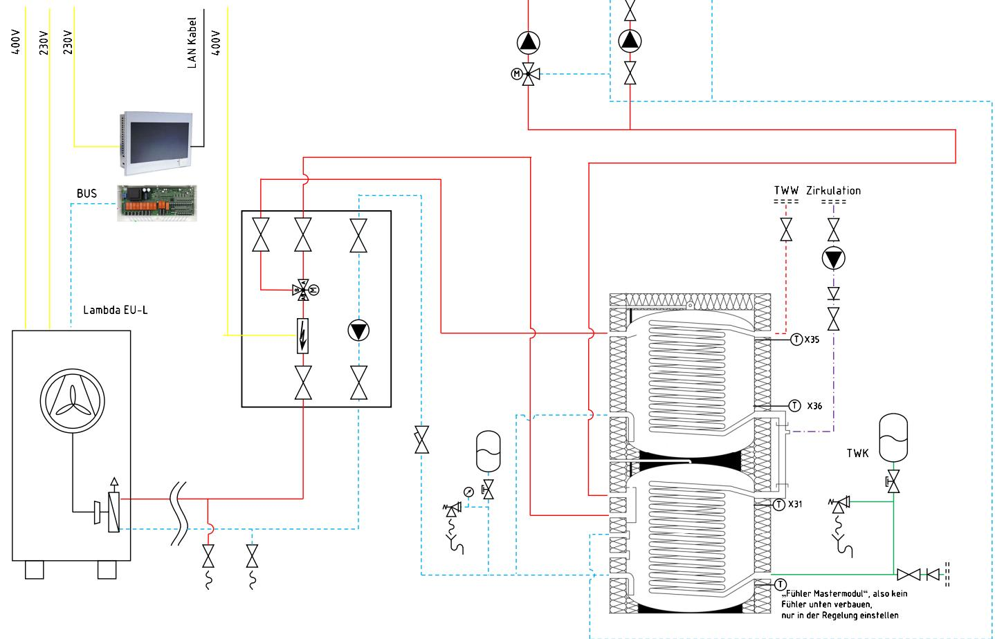
Beispielhydraulik: die Hydraulik ist jeweils mit dem Wärmepumpenhersteller abzustimmen, die jeweiligen Sicherheitsbestimmungen sind zu beachten.
